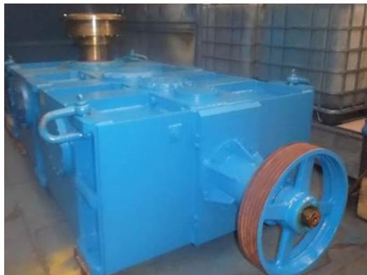
Tandwielkast voor verticale menger
