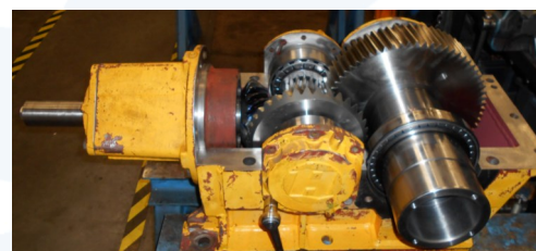
Tijdens revisie opsteekkast. Nieuwe holle as voor montage met krimpschijf
