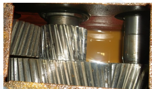
Tandschade binnenwerk centrale kast
