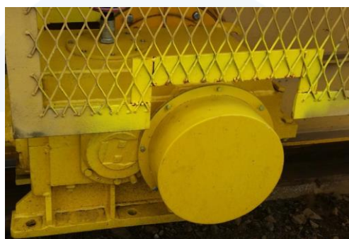
Boîte du réducteur après le montage. Couvercle de protection sur le sertissage
