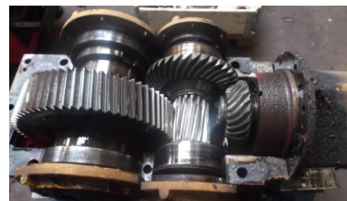
Mécanisme dans la boîte réducteur
