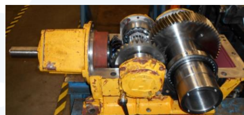
Boîte du réducteur pendant la révision. Nouvel arbre creux, pour montage avec disque à sertir
