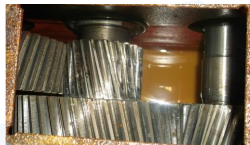
Dent endommagée dans la boîte centrale
