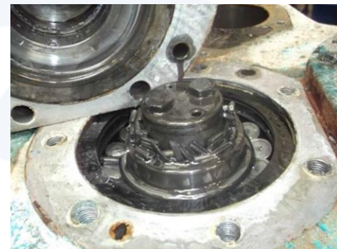
Frein récupérateur et palier défectueux
